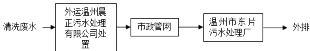
图 4-2 清洗废水处理工艺流程图
