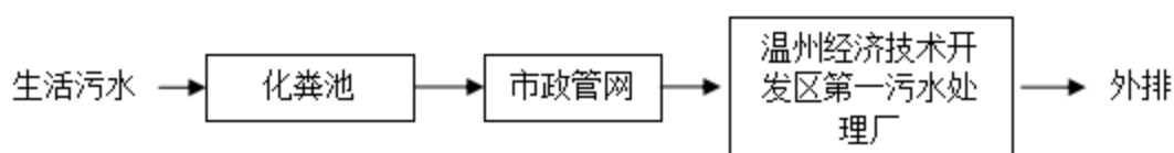
图 4-1 本项目生活污水处理流程图
